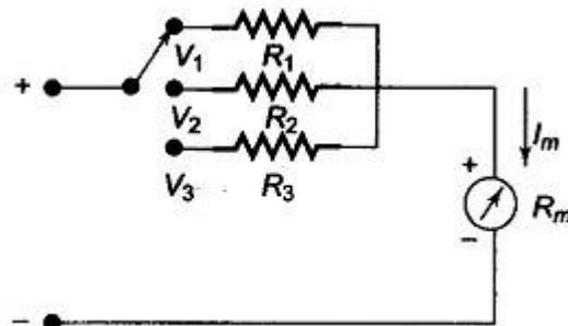
**Fig. 4.2** Multirange Voltmeter
