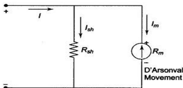
**Fig. 3.1** Basic dc Ammeter
