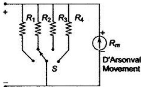
**Fig. 3.2** Multirange Ammeter
