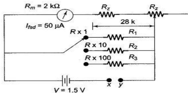
**Fig. 4.29** Multirange Ohmmeter
