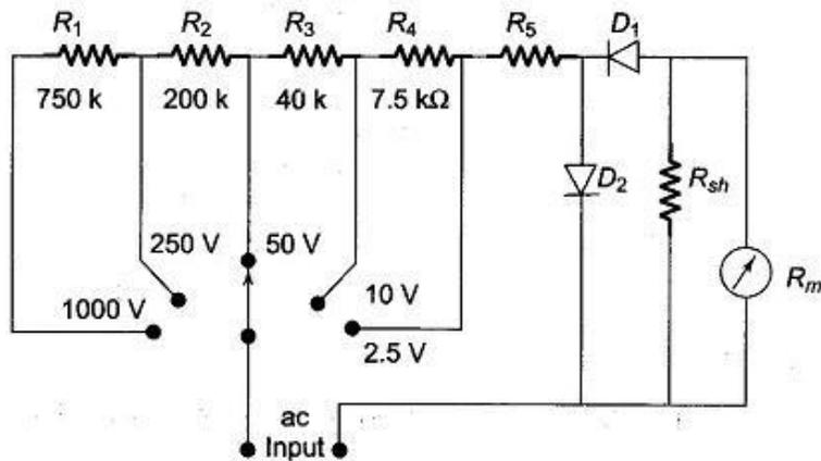
**Fig. 4.22** Multirange ac Voltmeter
