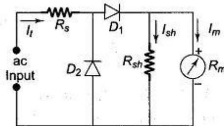
**Fig. 4.17** General Rectifier Type ac Voltmeter
